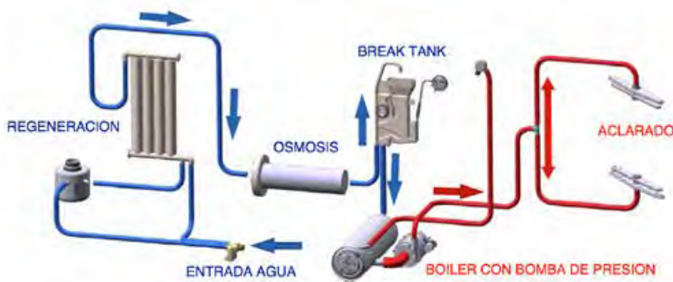
Esquema de funcionamiento N-50 EVO HY-NRG-OSMO
